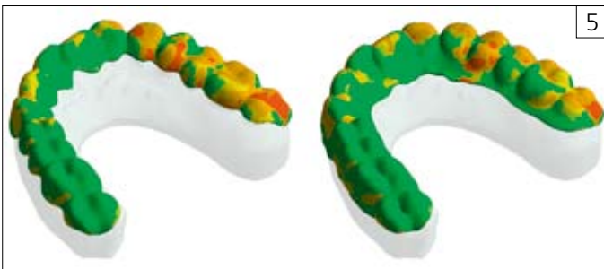
■Рис. 5. Напряжение сдвига элайнера с низкой обрезкой (слева) и высокой обрезкой (справа). Элайнеры с прямой обрезкой демонстрируют перераспределение упругой деформации в деформируемой области и правильное приложение силы по сравнению с фестончатой топологией
