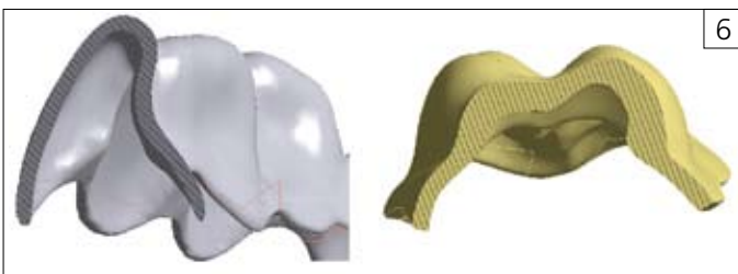
■Рис. 6. Неравномерность толщины виртуальной модели элайнеров, приближенная к реальной
