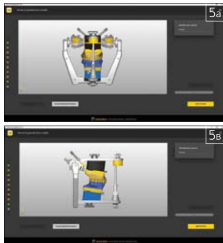
Рис. 5. Программное обеспечение AxioSnapMount (SAM). Этап генерации блоков-цоколей, позволяющих осуществить точный перенос положения моделей из виртуального артикулятора в физический
